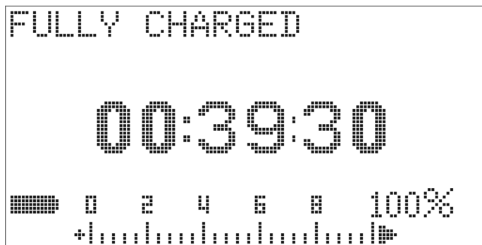
Abbildung 5-6 Vollständig geladen und im Erhaltungszustand
